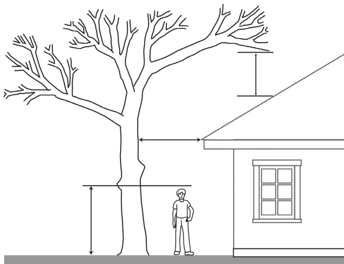
Figure 8: Élagage pour dégager les aires de travail
